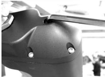
Si la batterie ne devait plus disposer de sa capacité complète après un long service sur le lieu d'intervention, le panneau peut aussi être descendu manuellement. Pour cela, dévisser la vis de couverture située sur la face supérieure de l'entraînement à broche. Insérer la clé Allen de 6 mm dans l'orifice le plus loin possible, alors le panneau peut être descendu en tournant vers la gauche.
