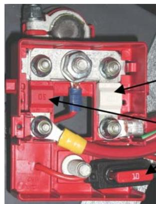
Borne batterie „+“ avec porte-fusible (Protection des chargeurs, équipements standards et de la prise pour feux de stationnement)
