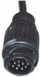
Si la remorque est placée sur la route de nuit sans véhicule tracteur, les feux arrière doivent être en service. La fonction est établie en insérant la fiche automobile dans la prise (option) installée sur la face extérieure du compartiment à accus. L'accu se trouvant dans la remorque alimente uniquement les feux arrière et les feux de gabarit latéraux
