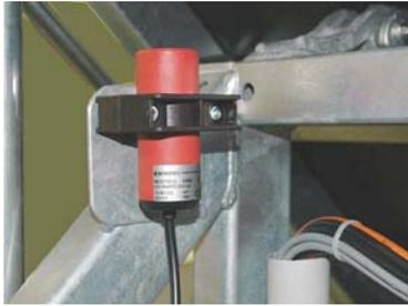
Les commutateurs de proximité inductifs servent à déterminer la position du panneau de signalisation et à commander le temps d'inertie du moteur à broche.
