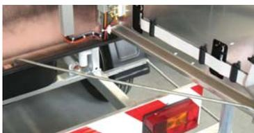
1. Retirer les deux tiges d'arrêt hors du compartiment à accus et les poser à portée de main près du panneau à LED.
