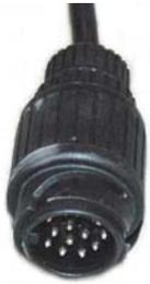
Si la remorque est équipée d'une adaptation automatique à la tension (option) pour les feux automobiles, ils peuvent être raccordés sans autres précautions à un véhicule 12 ou 24 V. Les ampoules des feux doivent dans ce cas toujours être conçues pour une tension de 12 V.
