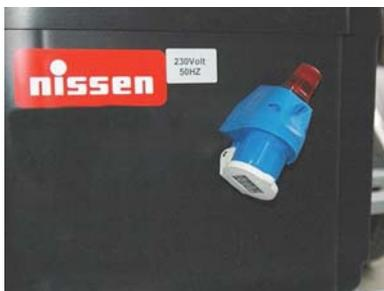
1. Connecter le câble de recharge sans tension avec fiche européen du câble de recharge du compartiment à accus.
