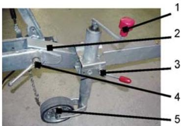
La hauteur du dispositif d'attelage du timon peut être adaptée avec précision à la hauteur de l'attelage du véhicule tracteur au moyen de l'articulation.
