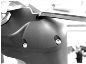
Si l'accu ne devait plus disposer de sa capacité complète après un long service sur le lieu d'intervention, le panneau peut aussi être descendu manuellement. Pour cela, dévisser la vis de couverture située sur la face supérieure de l'entraînement à broche. Insérer la clé carrée de 6 mm dans l'orifice obtenu le plus loin possible, alors le panneau peut être descendu en tournant vers la gauche.
