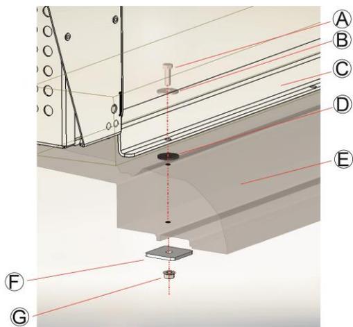
Séquencement de la visserie sur le profilé aluminium et le pavillon du véhicule :
