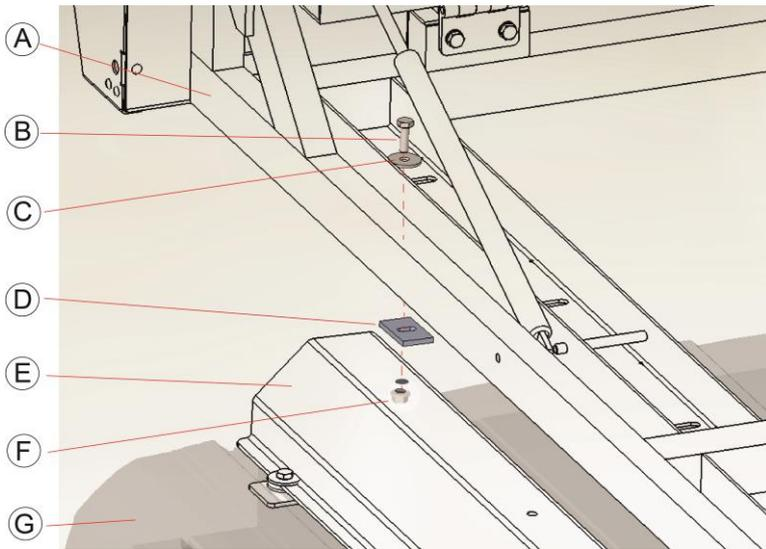
Séquencement de la visserie du châssis sur le profilé aluminium :
