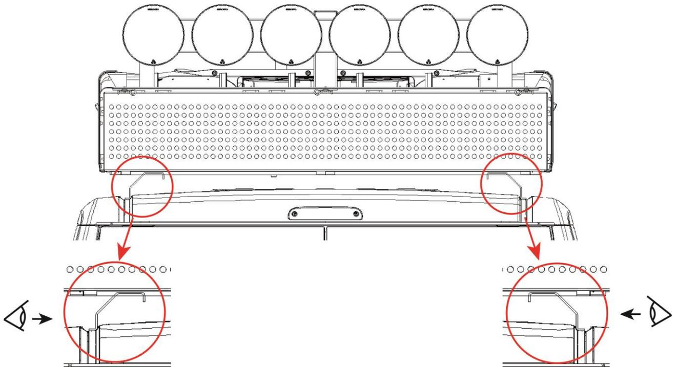
Emplacement de perçage sur véhicules de type BOXER et DUCATO :
