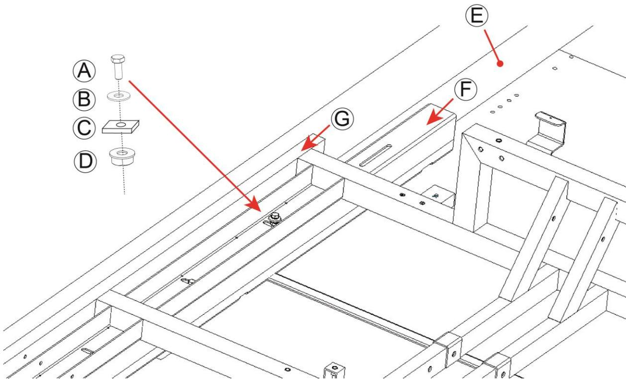
Séquencement de la visserie sur le châssis sur le profilé posé sur le pavillon du véhicule (E) :
