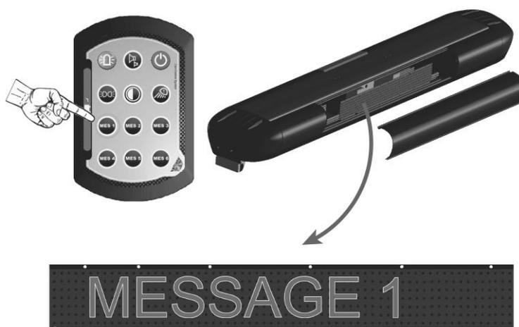
La carte à led du PML/PMV possède un capteur de luminosité. La puissance lumineuse des messages varie en fonction de la luminosité ambiante. En mode jour, la puissance lumineuse est maximale, et inversement, en mode nuit, la puissance lumineuse est minimale.
