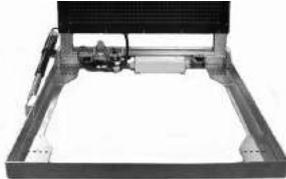
Le châssis inox sert à accueillir le boîtier LED et le mécanisme de pliage. Le châssis est fixé au véhicule à l'aide de supports supplémentaires.
