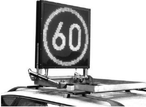
Un entraînement électromécanique de broche sert à actionner la montée et la descente. La commande de la montée et de la descente est assurée et surveillée par le système électronique central.
