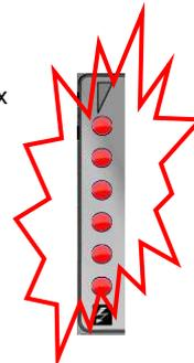
\*ATTENTION : Si tension chute brutalement en dessous de 11 volts, le système se coupe au bout de 15 secondes (En 12 volts comme en 24 volts). Ce symptôme est révélateur d'une batterie défectueuse ou usagée.
