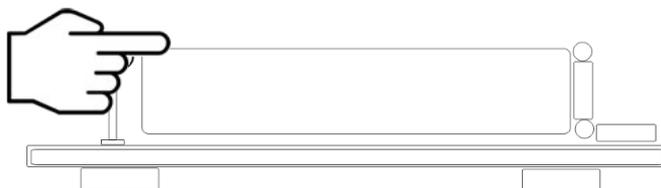
**Ne jamais poser la main sous la charnière durant l'opération de déploiement. La brusque remonté du triangle risquerait de l'écraser.**
