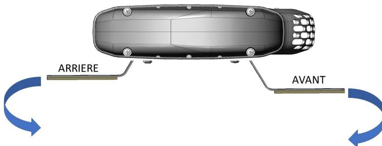
Pour ajuster l'horizontalité de la rampe, il est possible de plier (avec précaution) les bases des fixations.
