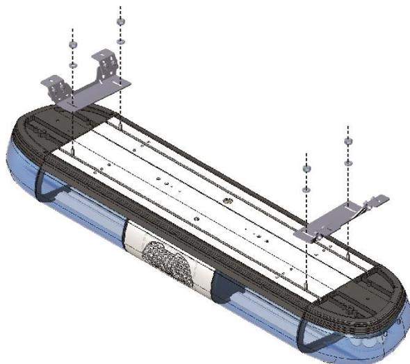
**Serrer les vis de fixation sur le socle de la rampe au couple de 3NM**
