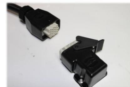
Prise de toit nouvelle génération, pour la maintenance et le transfert vers un prochain véhicule
