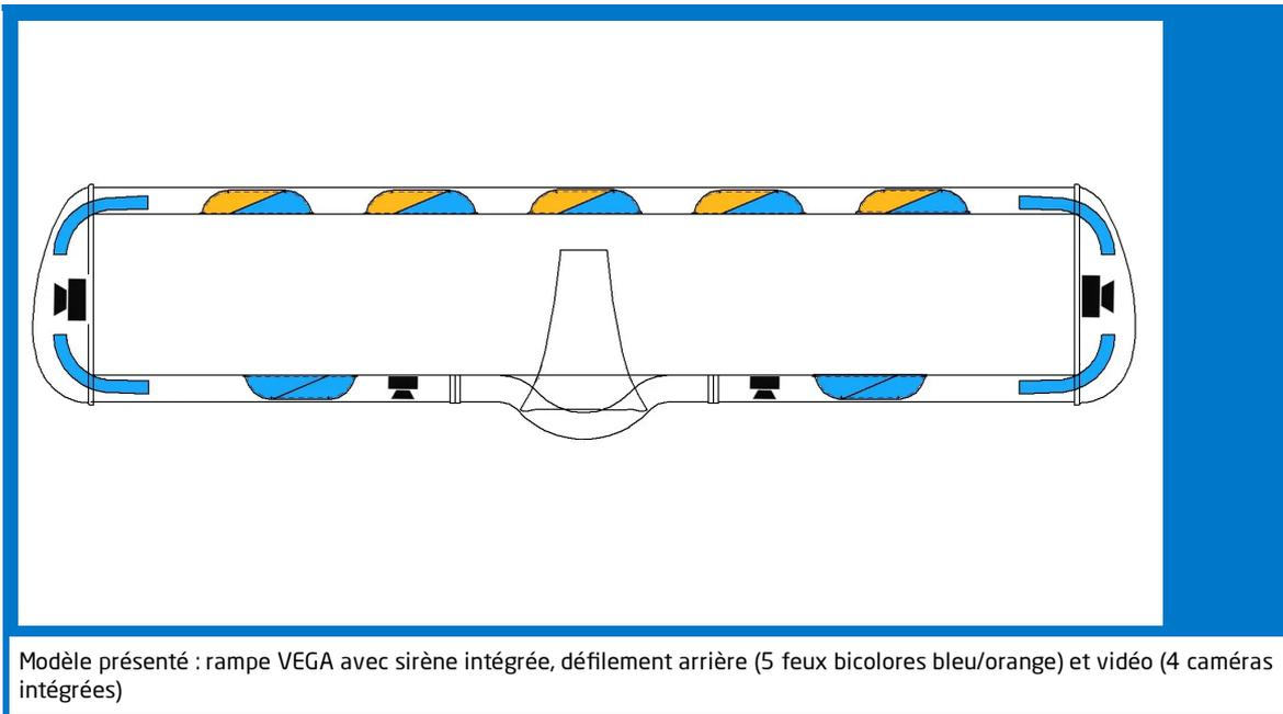
Modèle présenté : rampe VEGA avec sirène intégrée, défilement arrière (5 feux bicolores bleu/orange) et vidéo (4 caméras intégrées)
