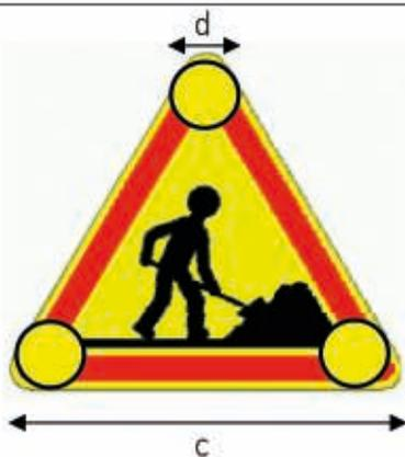
Les feux intégrés à l'intérieur du triangle doivent respecter cette formule  $d < 0.15c$  → cela signifie que le diamètre des feux ne doit pas dépasser 15% de la taille de la base du triangle (voir schéma ci-dessous)
