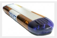
La qualité et la longévité des rampes M sont reconnues, MERCURA vous propose donc de mettre à jour votre rampe M avec la technologie à leds. Ces kits de mise à jour permettent de transformer votre rampe à gyrophares halogènes ou au xénon en rampe à Leds, sans aucune modification de l'installation sur le véhicule. Vous conserverez ainsi les qualités et le design de la rampe M, en y apportant tous les avantages du Gyroled® en particulier l'économie d'énergie.
