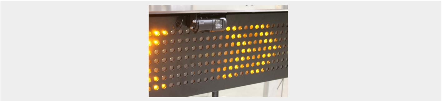
**Système vidéo composé de 2 caméras de rétro vision pour sécuriser les interventions des agents, identifier les usagers de la route en direction du véhicule et faciliter les manœuvres pour l'attelage de remorques.**
