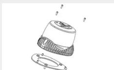
Adaptateur ISO pour [Gyroled M130](#) pour un montage par le dessus.
